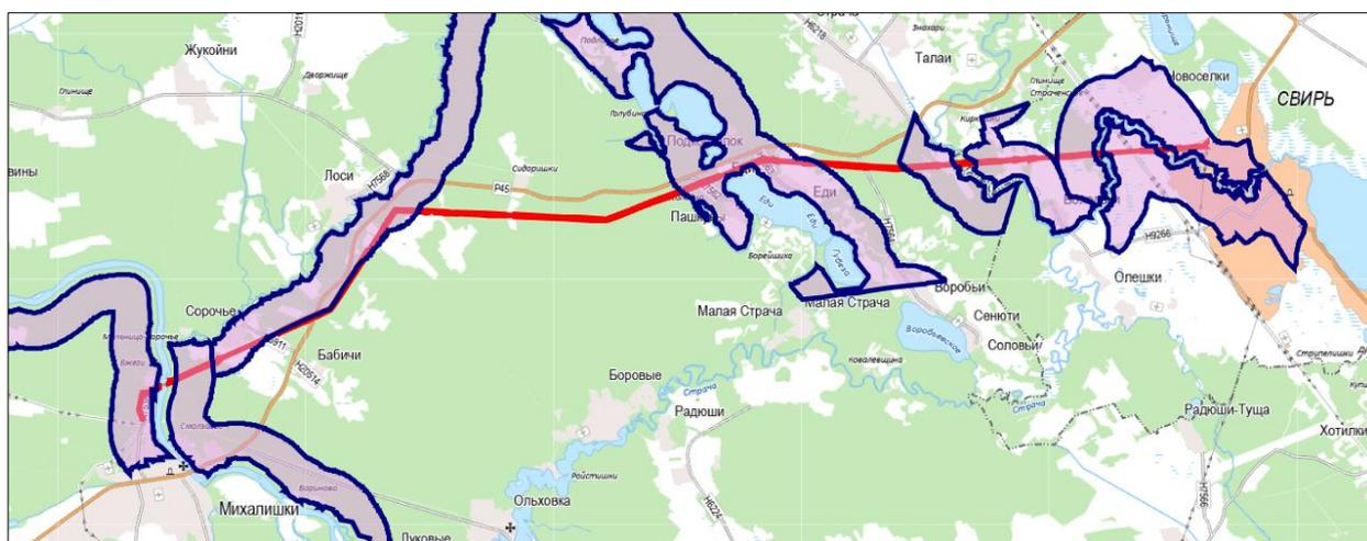
Рисунок 3.39 – Размещение линии электропередачи относительно водоохранных зон р. Вилии, Сорочанских озер, р. Страчи, р. Свирицы (перечислены с запада на восток)
