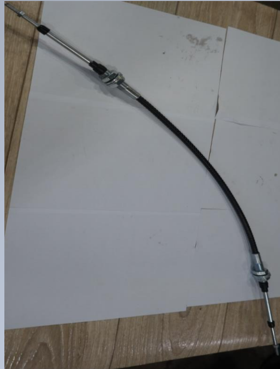
Трос дистанционного управления подачей топлива тракторных двигателей МТЗ
