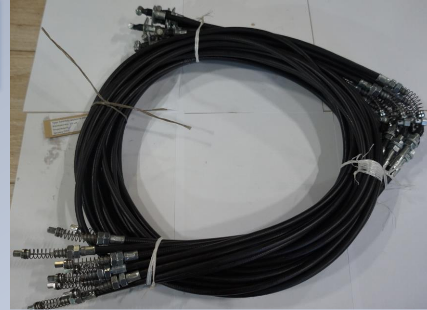
Трос дистанционного управления акселератором автомобилей МАЗ
